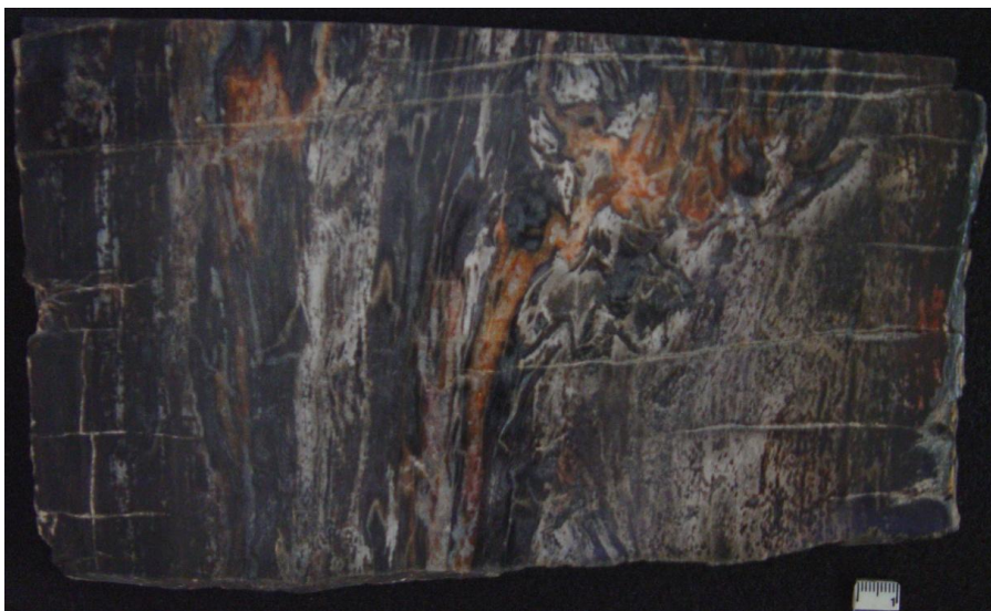
FIGURA 4 – AMOSTRA UFPR 517 PB. SEÇÃO LONGITUDINAL, FACE POLIDA MOSTRANDO FRATURAS TRANSVERSAIS E LONGITUDINAIS PREENCHIDAS.
