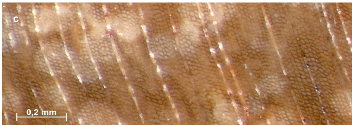
FIGURA 8 a), b) e c) – AMOSTRA UFPR 522 PB SEÇÃO TRANSVERSAL POLIDA. a) FRAGMENTO LENHOSO COM MUITAS FRATURAS E ÓXIDOS DA REGIÃO EXTERNA. b) XILEMA SECUNDÁRIO PERMINERALIZADO E FRATURA COM CALCEDÔNIA E QUARTZO. c) CÉLULAS COMPRIMIDAS, EVIDENCIANDO TORÇÕES E ROMPIMENTOS.
