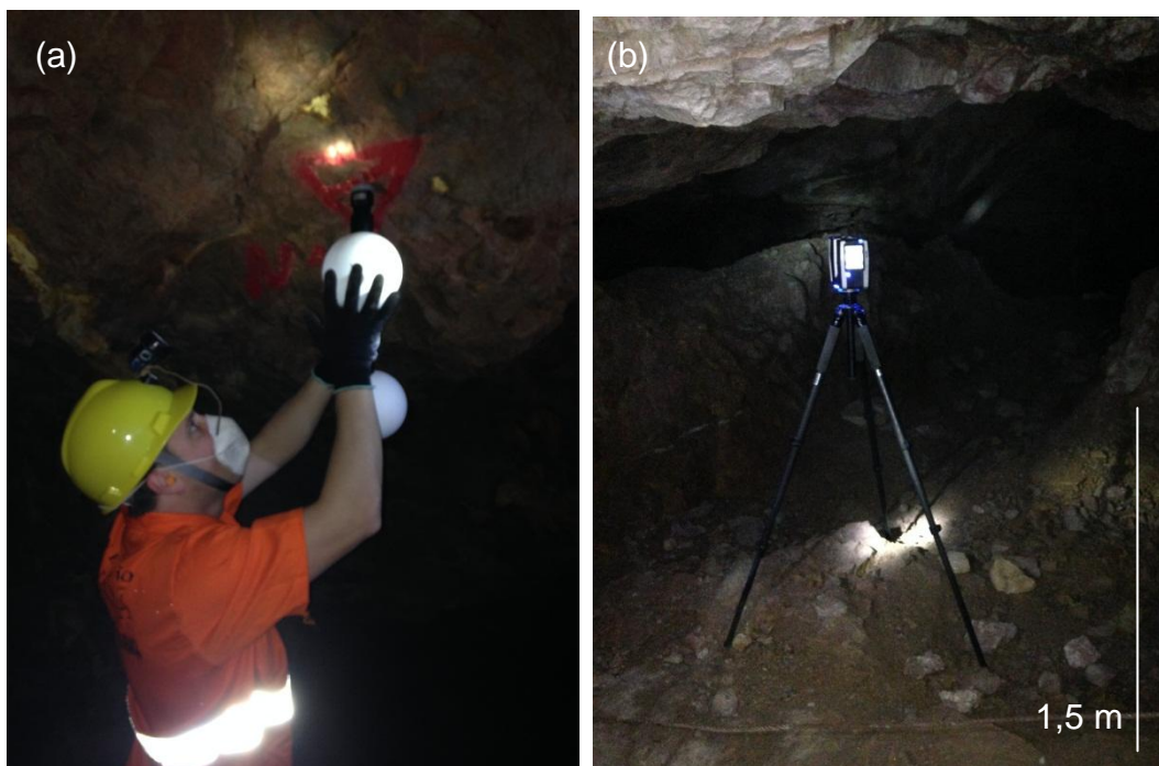
Figura 12: Fotografias do levantamento de campo. a) Colocação do alvo esférico no ponto de coordenadas conhecidas. b) Equipamento Laser Scanner em funcionamento.
