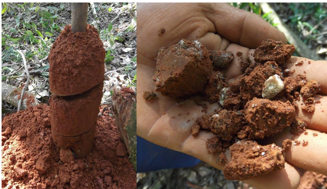
Figura 7 – Imagem demonstrando o material recolhido pela sondagem do trado manual no ponto de trado 04, com o detalhe de fragmentos de mármore dolomítico em meio a solo castanho avermelhado argiloso.
