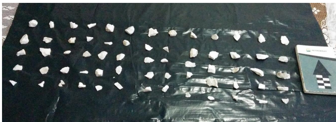
Figura 9 – Todos os fragmentos que foram retirados para compor a amostra AM-01, retirados a cada dez centímetros da frente de lavra do afloramento 01, com volume aproximado de 1 cm 3 .
