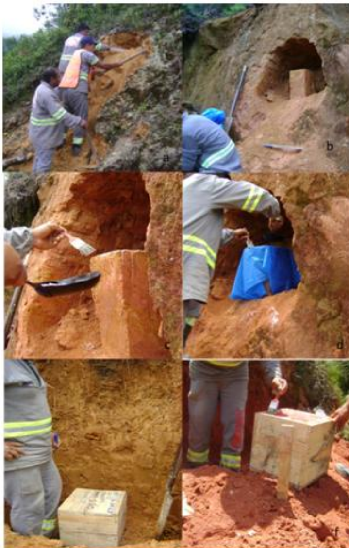
Figura 23: Procedimento de coleta e armazenamento dos blocos de amostra de solo indeformada de Migmatito Oftálmico. Fonte: Silva Vaz (2014).
