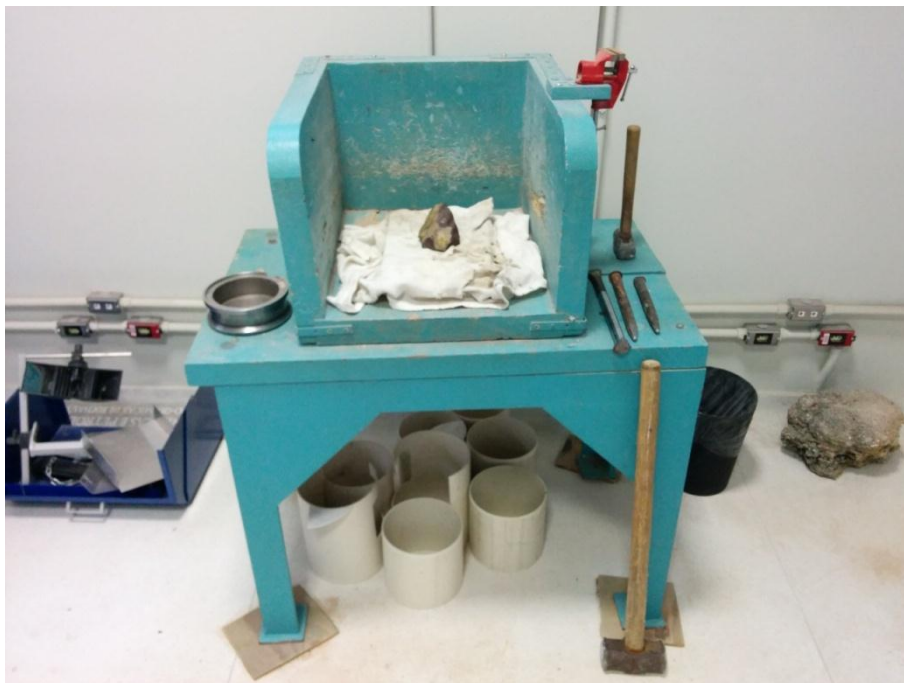
FIGURA 3 - Processo de quebra ou redução de amostras de forma manual.
