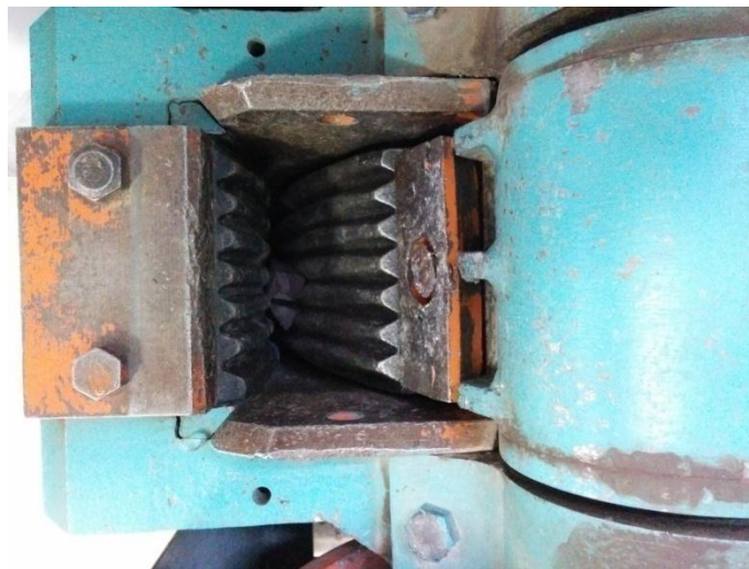
FIGURA 5 - Detalhe das placas dentadas do britador de mandíbula.
