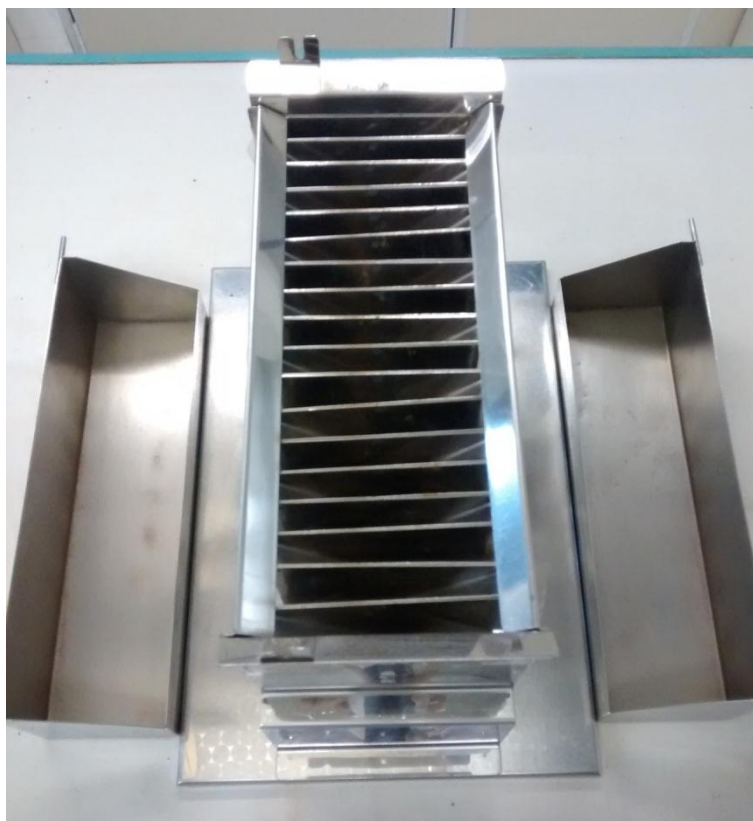
FIGURA 8 - Quarteador utilizado na seleção das amostras britadas.
