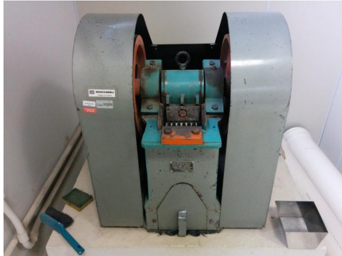
FIGURA 4 - Britador de mandíbula utilizado para britagem das amostras.
