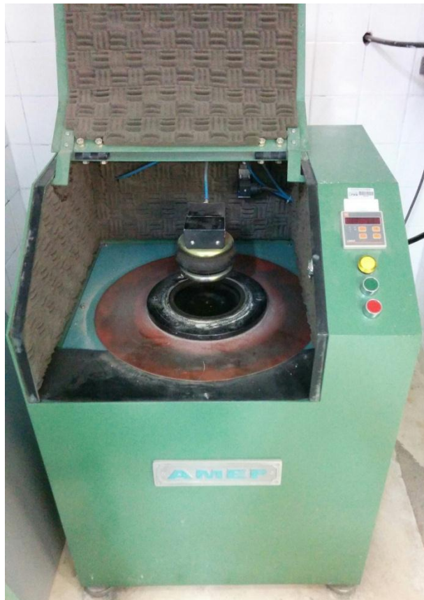
FIGURA 10 - Pulverizador utilizado para redução das amostras quarteadas.
