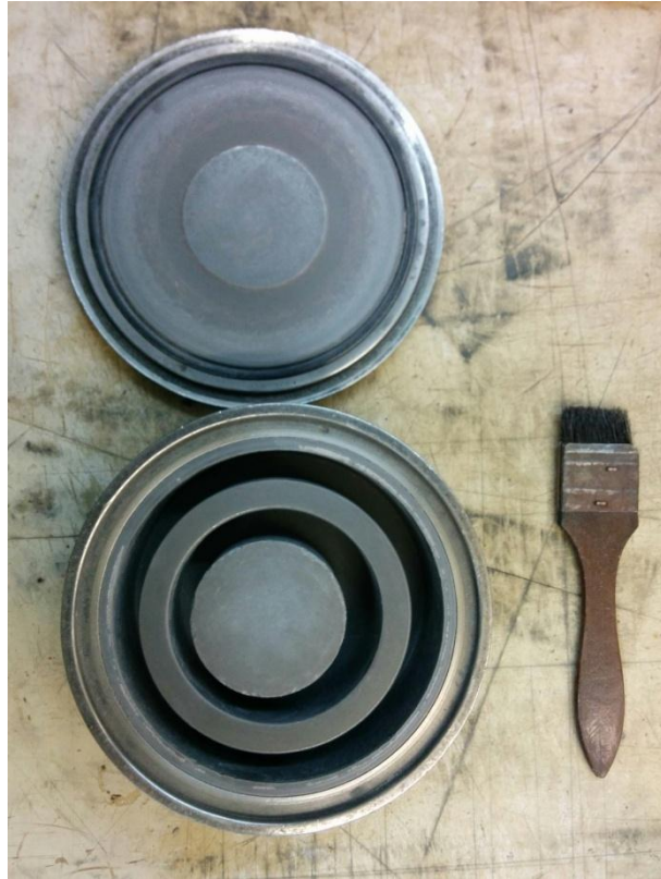
FIGURA 9 - Conjunto composto por panela com interior de tungstênio utilizada para pulverização.
